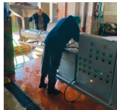
Foto 2: Protiprúdová extrakcia hrozňových výliskov
